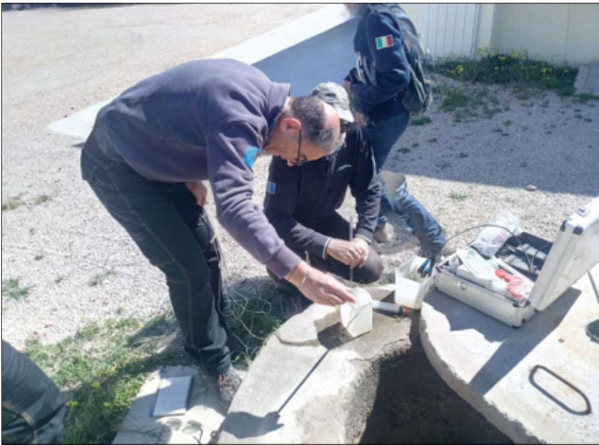
Εικόνα 20α Δειγματοληψία υπόγειων υδάτων με επιτόπια μέτρηση pH και θερμοκρασίας
