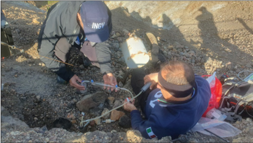
Εικόνα 18 Δειγματοληψία αερίων στη φουμαρόλη (Νέα Καμένη)
