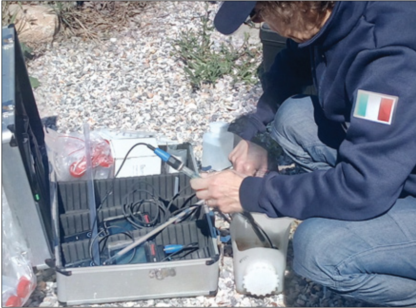
Εικόνα 20 Δειγματοληψία υπόγειων υδάτων με επιτόπια μέτρηση pH και θερμοκρασίας
